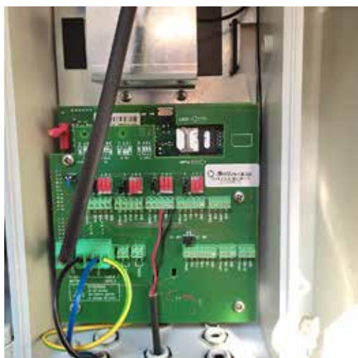
Scheda di controllo con sim telefonica
